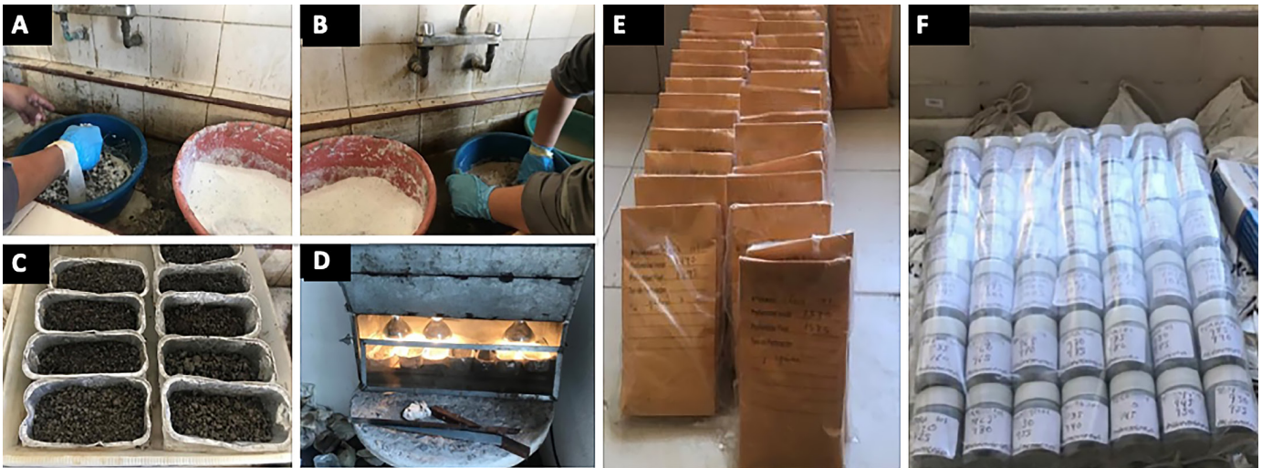
Figura 5. (A–B). Lavado de recortes con jabón biodegradable, (C–D) Secado en horno a 100°C. (E–F) Empaquetado de las muestras.
