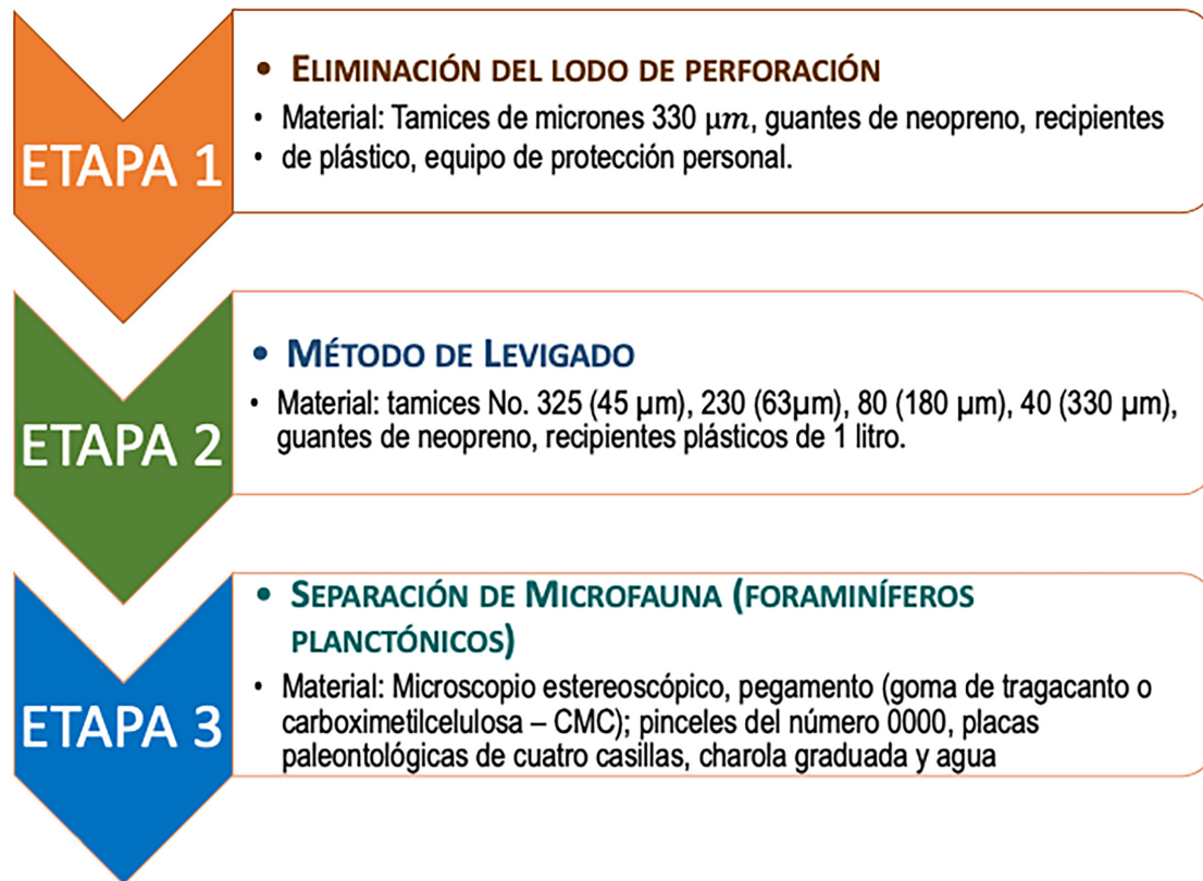
Figura 4. Diagrama de flujo simplificado para el procesamiento de las muestras de canal incluyendo el material de cada etapa.
